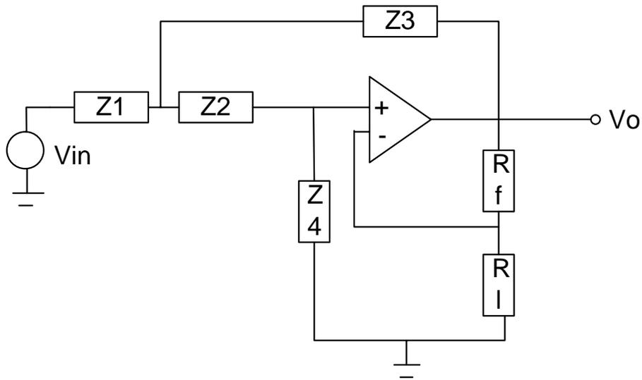
$$\frac{V_0}{V_{in}} = \frac{A_0 Z_3 Z_4}{Z_1 Z_2 + Z_2 Z_3 + Z_3 Z_4 + Z_1 Z_3 + Z_1 Z_4 (1 - A_0)}$$
